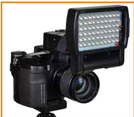
Illuminatore LED 3W collegabile direttamente ad una fotocamera tramite contatto caldo. Caratteristiche: Dimensioni: 7,5x11cm - Peso: 220g (senza batterie) - Potenza: 1,5-3W selezionabile - Lumen: 150/m - Temperatura di colore: 5600°K - Alimentazione: 4 batterie AA.
