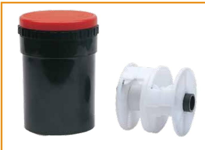
E' una sviluppatrice a perfetta tenuta di luce e d'acqua. La rapidità di riempimento e svuotamento e il sistema di agitazione per capovolgimento e rotazione delle spirali con saltello assiale automatico, permettono un ottimale sviluppo della pellicola. Tank A-P Compact contiene 2 spirali 35 mm.
