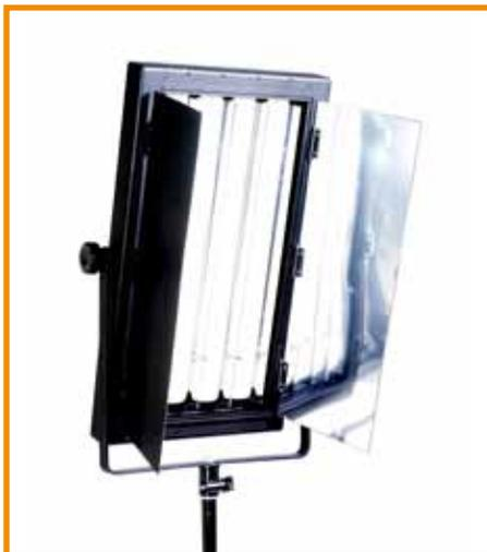
illuminatore fluorescente professionale a luce daylight bilanciata 5400°K. Emissione luminosa pari a 900W ma con un consumo di soli 220W. FL-900, corredato da 4 speciali lampade fluorescenti "Dulux L55W Osram", genera poco calore. E' possibile selezionare 2+2 lampade variando la potenza senza variare la temperatura di colore.
