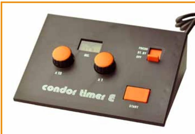
Temporizzatore elettronico per stampa bianco/nero con tempi di esposizione da 0,5 a 119 secondi. Ingranditore collegabile direttamente, con potenza massima della lampada di 1000 Watt. Precisione della temporizzazione  $\pm 2\%$  su tutte le scale. Ripetibilità dei tempi: immediata. Protezione: totale con fusibile interno. Carrozzeria: ABS nero antiurto.
