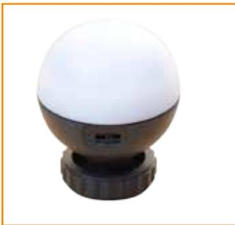
Fotocellula omnidirezionale con commutatore a 3 posizioni: quella con 1 punto sincronizza flash senza pre-lampo; la centrale spegne l'apparecchio e quella con 2 punti ignora il pre-lampo sincronizzando il flash effettivo. Digital Flash-Ball è alimentata da 2 batterie 3V al litio CR 2016 ed è sensibile fino a 30 metri.
