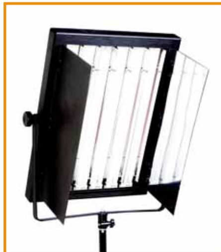
illuminatore fluorescente professionale a luce daylight bilanciata 5400°K. Emissione luminosa pari a 1100W ma con un consumo di soli 330W. FL-1100, corredato da 6 speciali lampade fluorescenti "Dulux L55W Osram", genera poco calore. E' possibile selezionare 2+2+2 lampade variando la potenza senza variare la temperatura di colore.
