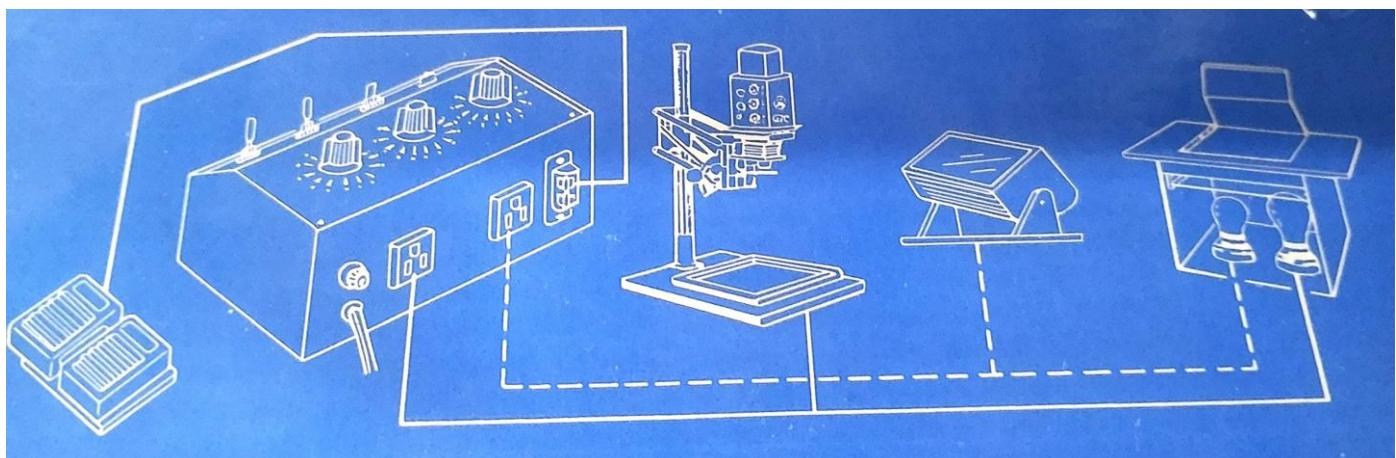
Temporizzatore elettronico per stampa bianco/nero con tempi di esposizione da 0,1 a 900 secondi. Ingranditore collegabile direttamente con intensità massima di 2 A. Precisione della temporizzazione  $\pm 0,5\%$  su tutte le scale. Ripetibilità dei tempi: immediata.
